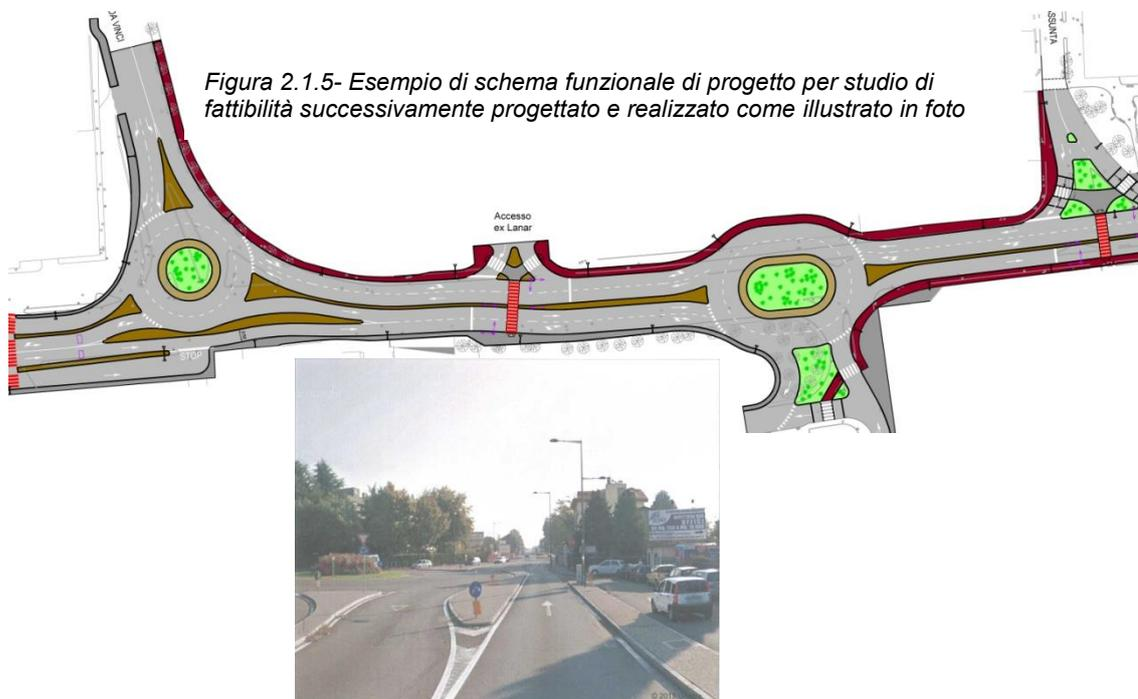
Figura 2.1.5- Esempio di schema funzionale di progetto per studio di fattibilità successivamente progettato e realizzato come illustrato in foto
