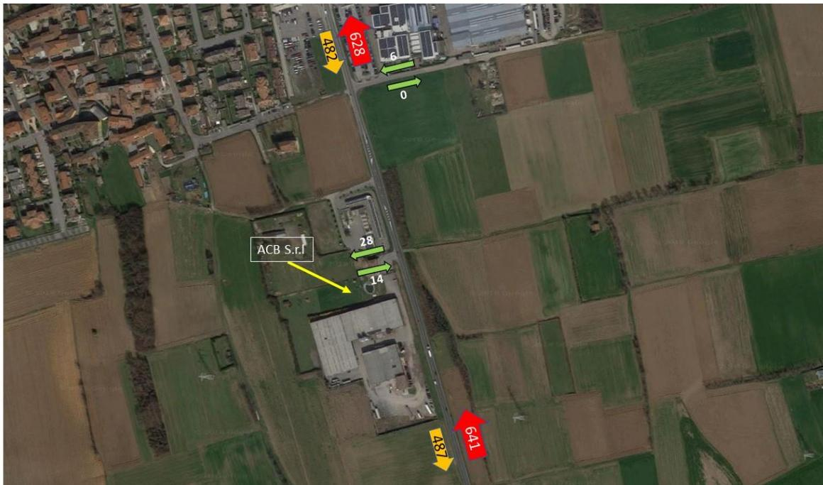
All'intersezione Viale Europa – Ingresso/Uscita dalla struttura oggetto di studio, si sono rilevati non solo i veicoli che transitavano lungo Viale Europa, ma anche i veicoli che accedevano o uscivano dagli spazi delle strutture che ospita la società ACB.
